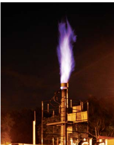
Podziemne zgazowanie węgla w KWK „Wieczorek” – spalanie gazów wylotowych. Projekt Huga
