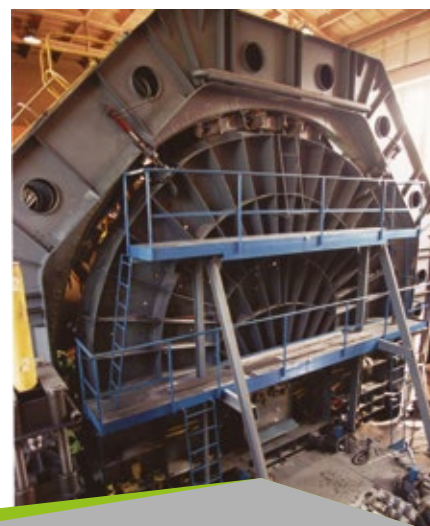
Stanowisko badawcze do badania odrzwi obudowy wyrobisk korytarzowych Test stand for testing arch support in roadways
