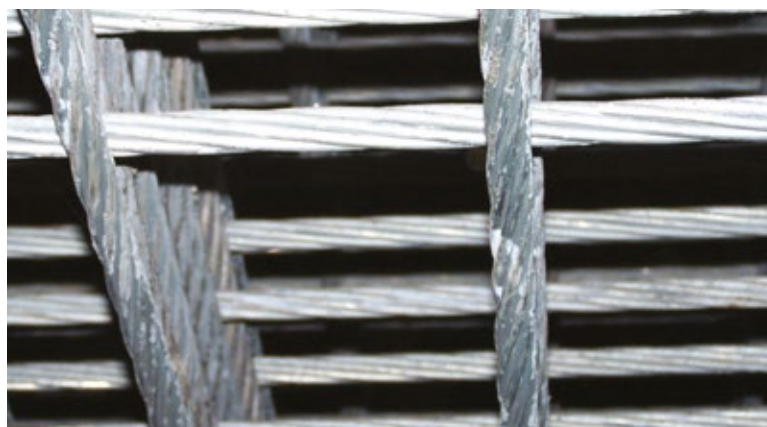
Mechaniczny układ ochronny z zastosowaniem zasady dyssypacji energii Mechanical safety system utilizing the principles of energy dissipation
