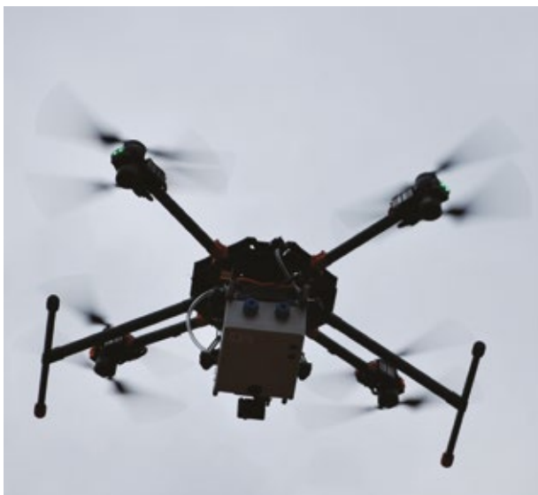
Mobilna platforma monitoringu wybranych parametrów niskiej emisji z wykorzystaniem dronów
