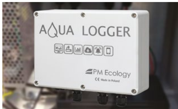
Stacja pomiaru zmian poziomu wód podziemnych Groundwater level changes measurement station
