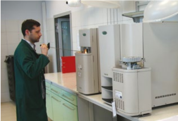
Automatyczny analizator do oznaczania siarki całkowitej TruSpec S firmy Leco
