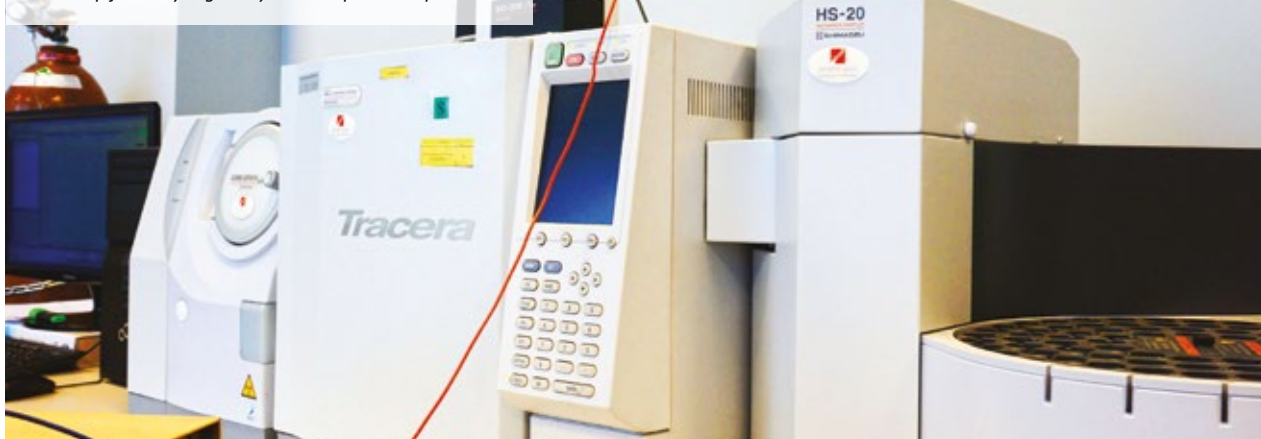
Stanowisko do oznaczania izotopów pary wody ciężkiej Test setup for analysing heavy water vapour isotopes
