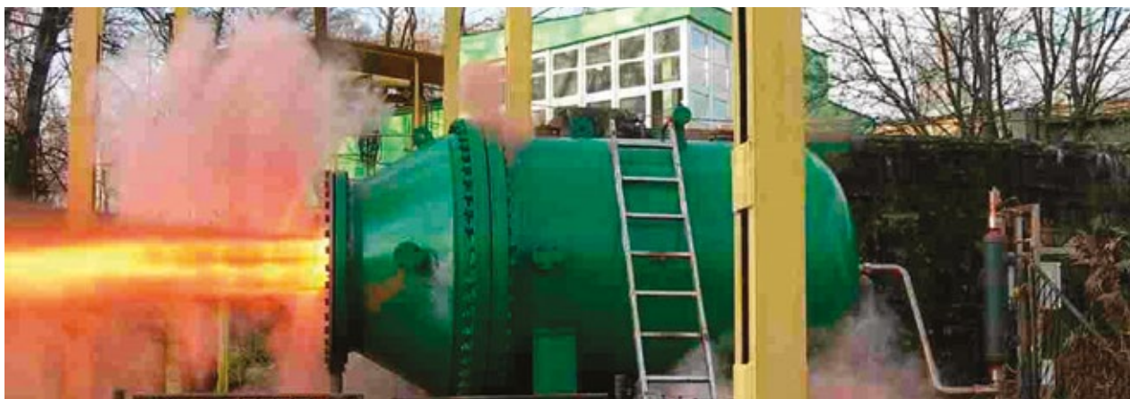
Wybuch pyłu w komorze doświadczalnej 5 m 3 Coal dust explosion in 5m 3 chamber
