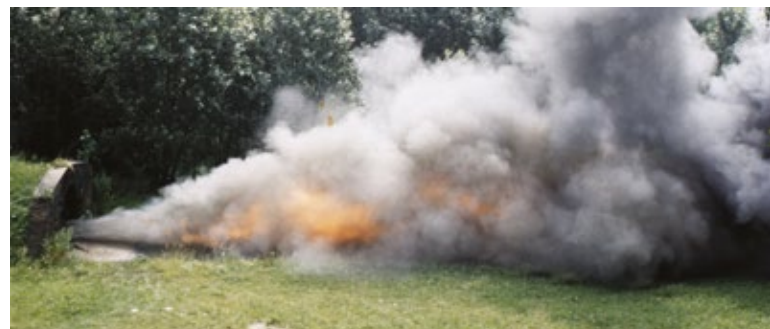
Wybuch pyłu węglowego w sztolni doświadczalnej 100 m Coal dust explosion in the experimental adit 100 m
