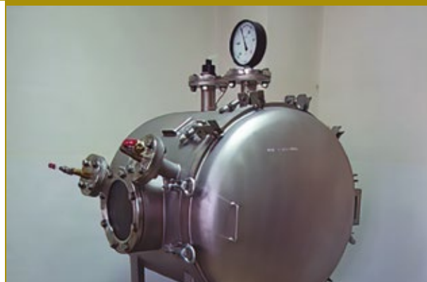
Stanowisko do badania szczelności przy obniżonym ciśnieniu z wykorzystaniem helu
