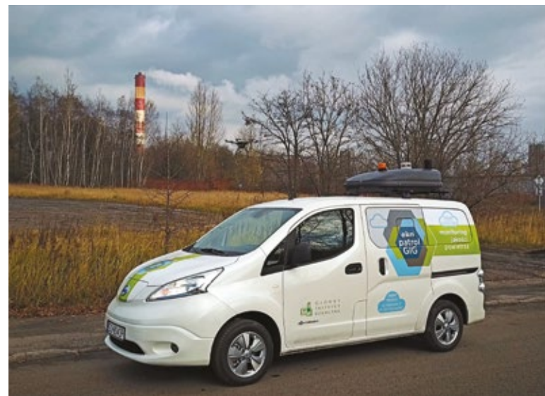
Laserowy system automatycznego pomiaru geometrii obudowy i wyposażenia szybów
