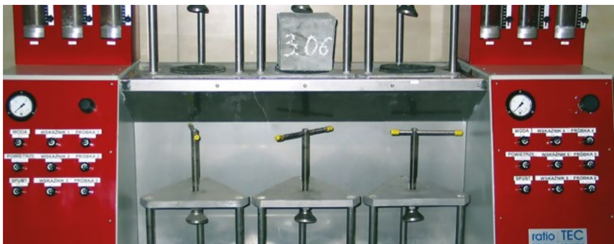
Aparat W.U.6 firmy Ratio TEC do badania wodoprzepuszczalności betonu W.U.6 apparatus by Ratio TEC for testing water permeability of concrete
