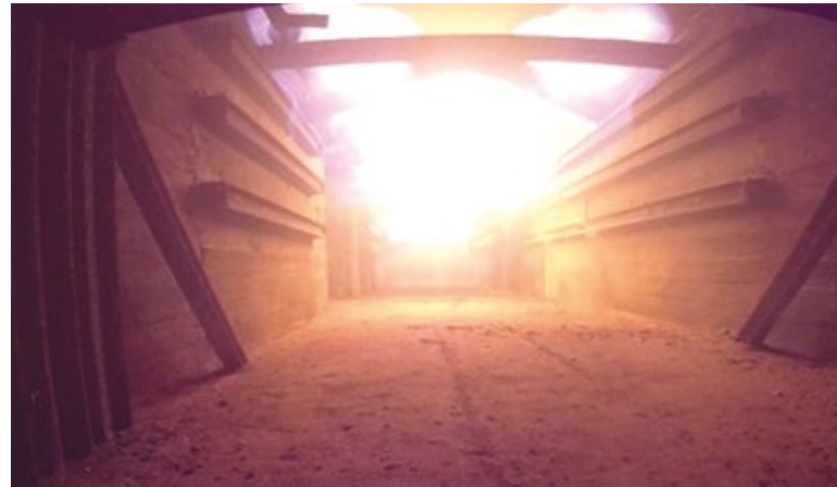
Chodnik badawczy 400-metrowy i widok wybuchu metanu 400-meter research gallery and the view of the methane explosion
