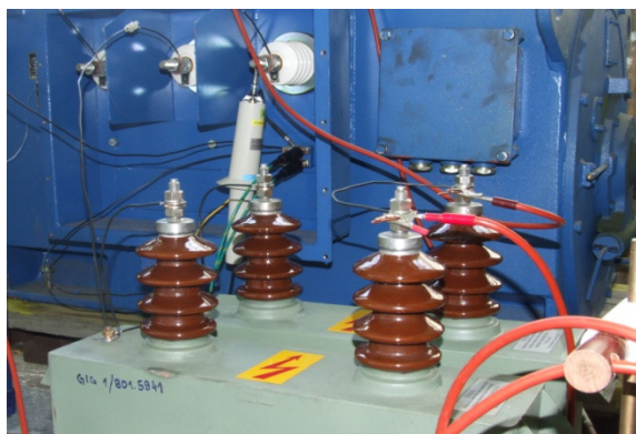
Rys. 4. Układ pojemnościowy HV wraz z sondą pomiarową
