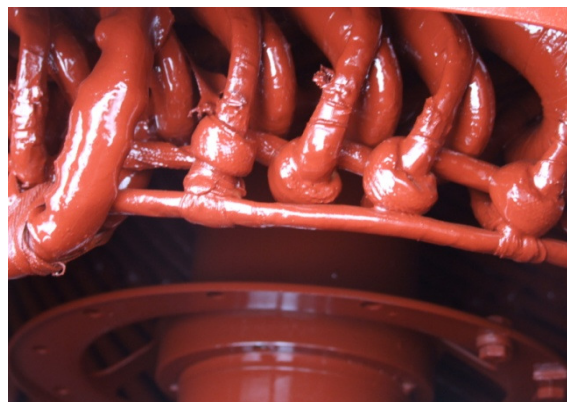
Rys. 6. Izolacja uzwojeń badanego silnika
