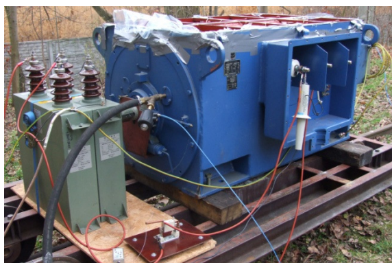
Rys. 8. silnik 1200kW / 6kV produkcji ZME „EMIT” w Żychlinie na stanowisku badawczym
