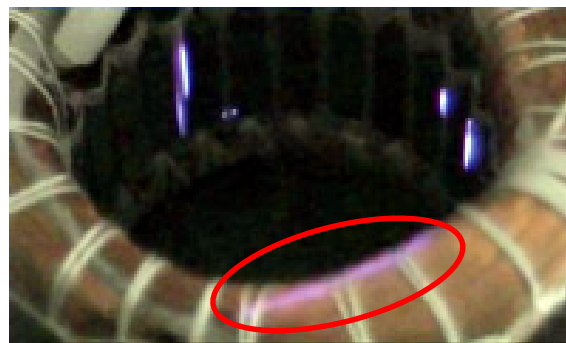
Rys. 1. Wylądowanie w uzwojeniu silnika - zjawisko "korony" (źródło: Chroma System Solution)
