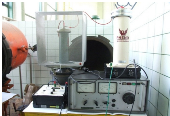
Rys. 3. Generator wysokich napięć wraz z woltomierzem HV prod. PHENIX Technologies
