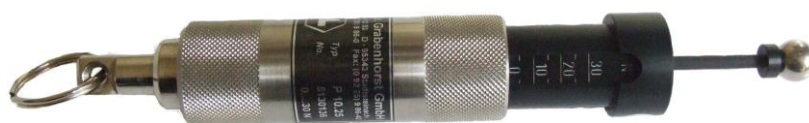
Rys. 2 – Próbnik dostępu - kula o średnicy 12,5mm, wykorzystywana do sprawdzania stopnia ochrony przed wnikaniem obcych ciał stałych – pierwsza cyfra charakterystyczna – 2.
