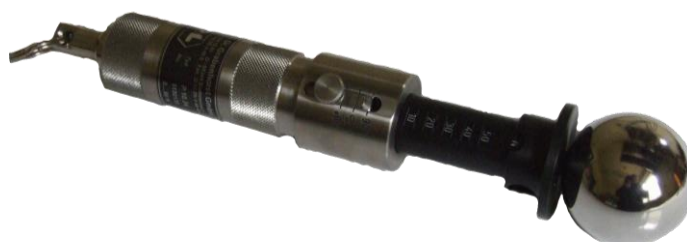
Rys. 1 – Próbnik dostępu - kula o średnicy 50mm, wykorzystywana do sprawdzania stopnia ochrony przed dostępem do części niebezpiecznych oraz przed wnikaniem obcych ciał stałych – pierwsza cyfra charakterystyczna – 1.
