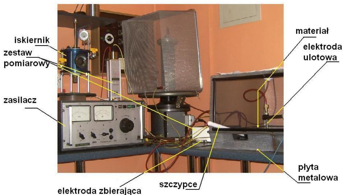
Fot. 2: Stanowisko do elektryzacji przez indukcję.
