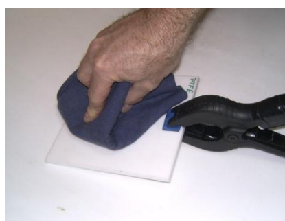
Fot. 1: Elektryzacja kontaktowo-tarciowa.
