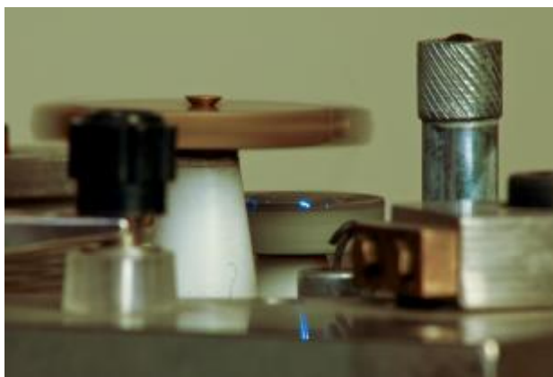
Widok wnętrza iskiernika - urządzenia do badania w mieszaninach wybuchowych
