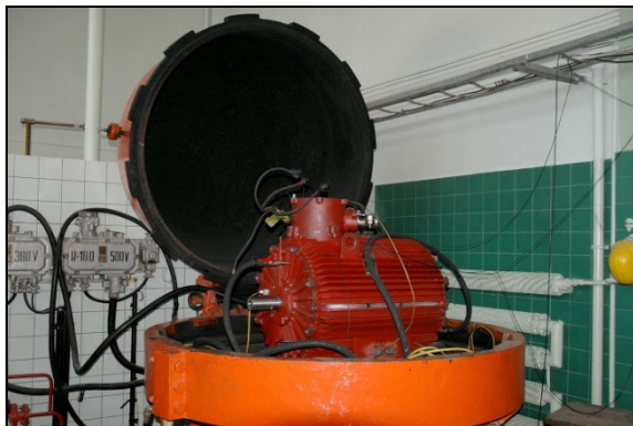
Rys. 2. Silnik w osłonie ognioszczelnej na stanowisku badawczym
