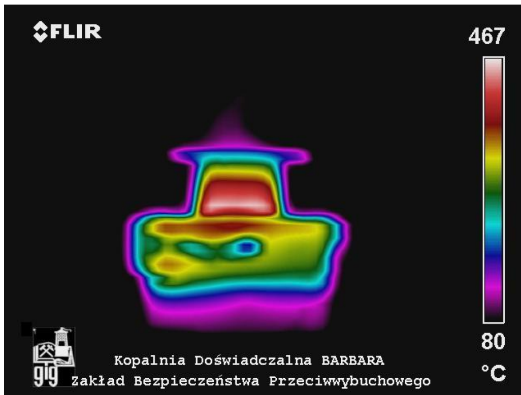
Rysunek 2. Obraz termowizyjny końcowego przerywacza płomienia podczas palenia długotrwałego.
