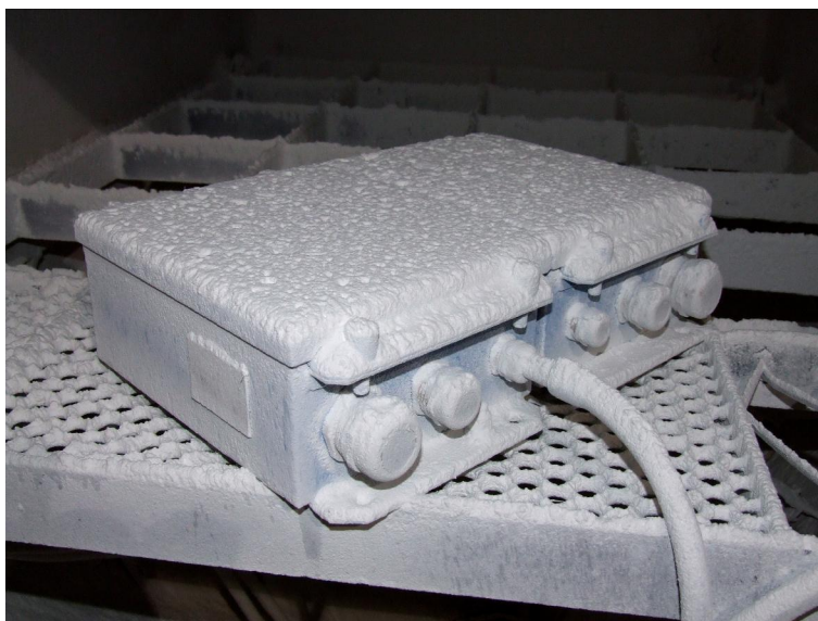
Fot. 2 Badanie stopnia ochrony IP6X w komorze pyłowej
